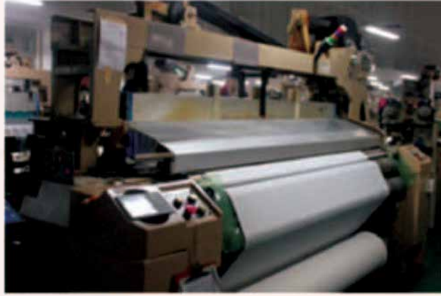
चित्र 3.6: वाटरजेट करघा –कपड़े पर चमक को ध्यान से देखें, यह कपड़े के पानी की वजह से गीला होने के कारण है ।
